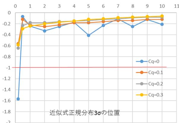
図 2-16  $\delta$ で補正後の近似正規分布と標準モデル分布の差(3 $\sigma$ の位置)
