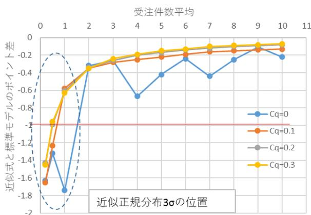
図 2-13 Q=10、その変動係数 0~0.3 での近似正規分布と標準モデル分布のポイント差
