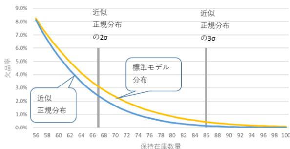
図 2-11 近似正規分布の  $2\sigma$  と  $3\sigma$  の位置と標準モデル分布
