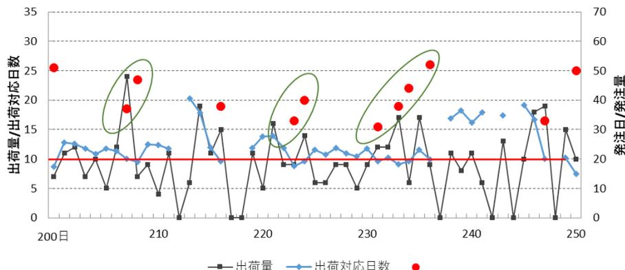
図 7-4 従来方式の出荷量、出荷対応日数、補充発注日と発注量の推移
