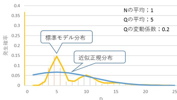
図 2-8 Q=5、その変動係数が 0.2 のときの D の分布(標準モデル分布)と近似正規分布
